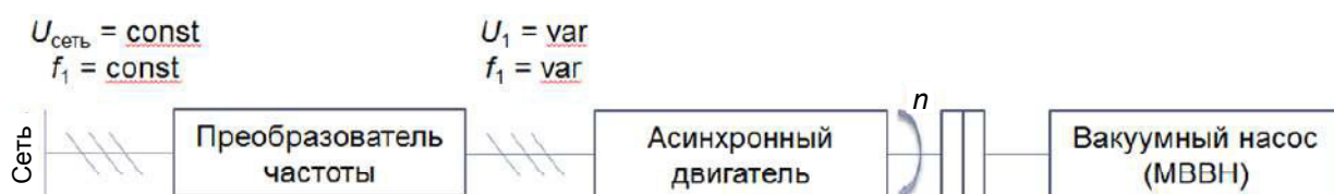
Рис. 7. Схема подключения электродвигателя к МВВН
