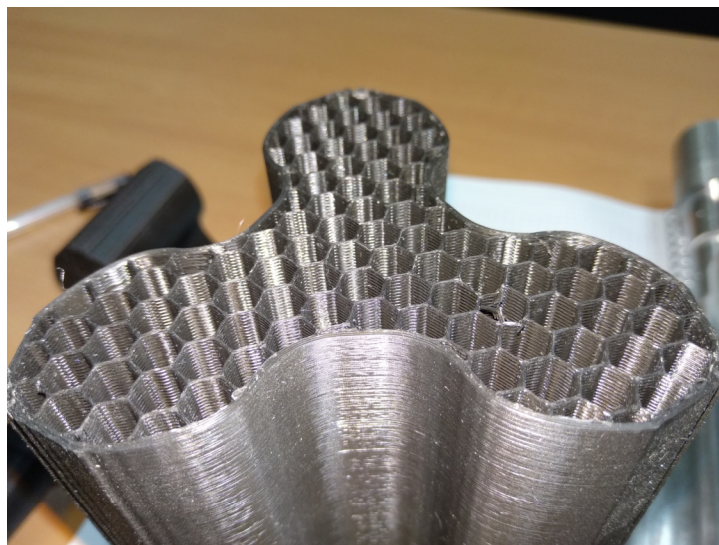
Рис. 7. Фото разреза ротора, выполненный на 3D принтере Fig. 7. Photo of the rotor section made on a 3D printer
