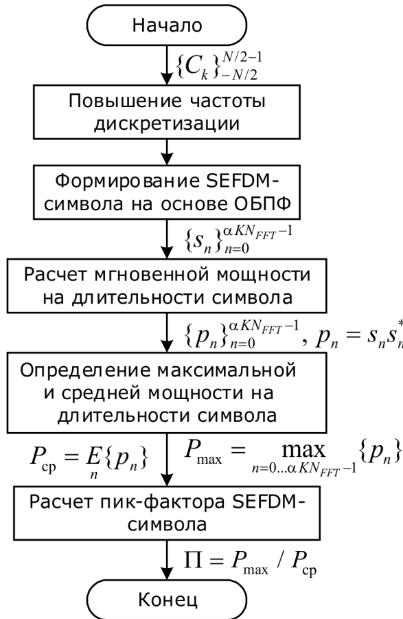
Рис. 4. Блок-схема алгоритма расчета пик-фактора одного OFDM- или SEFDM-символа
