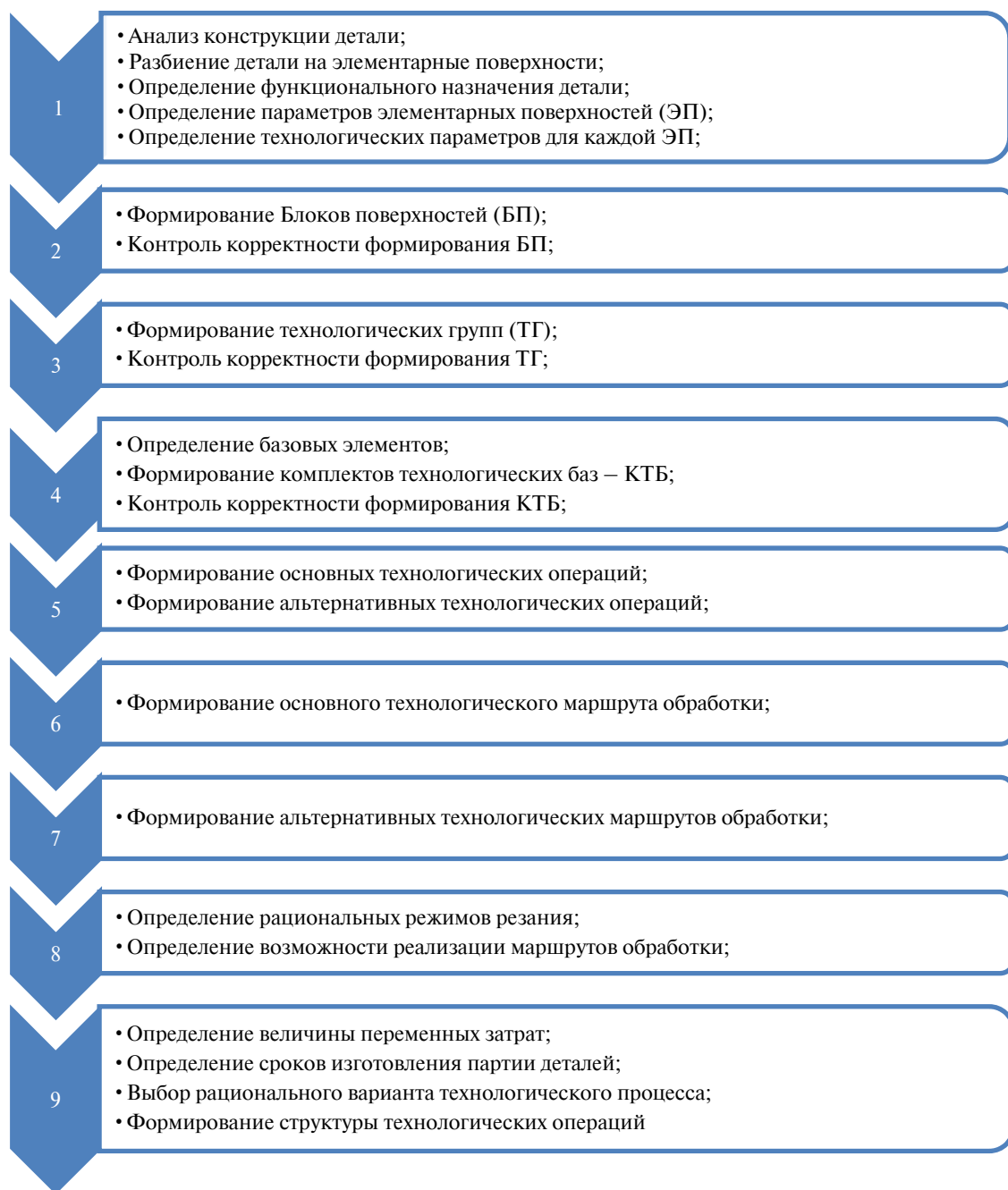
Рис. 3. Схема первого уровня имитационной модели технологической подготовки производства Fig. 3. The Scheme of the first level of the simulation model of technological preparation of production
