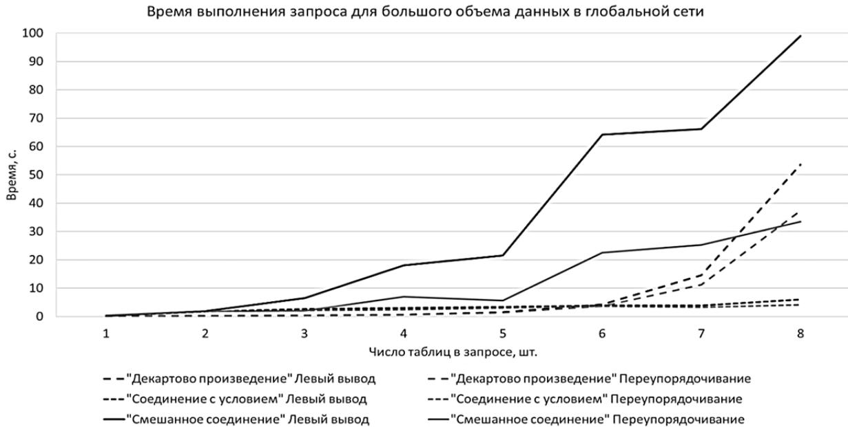
Рис. 8. Зависимость времени выполнения плана от числа таблиц в запросе для большого объема данных для запросов типа «декартово произведение», «соединение с условием» и «смешанное соединение» в глобальной сети
