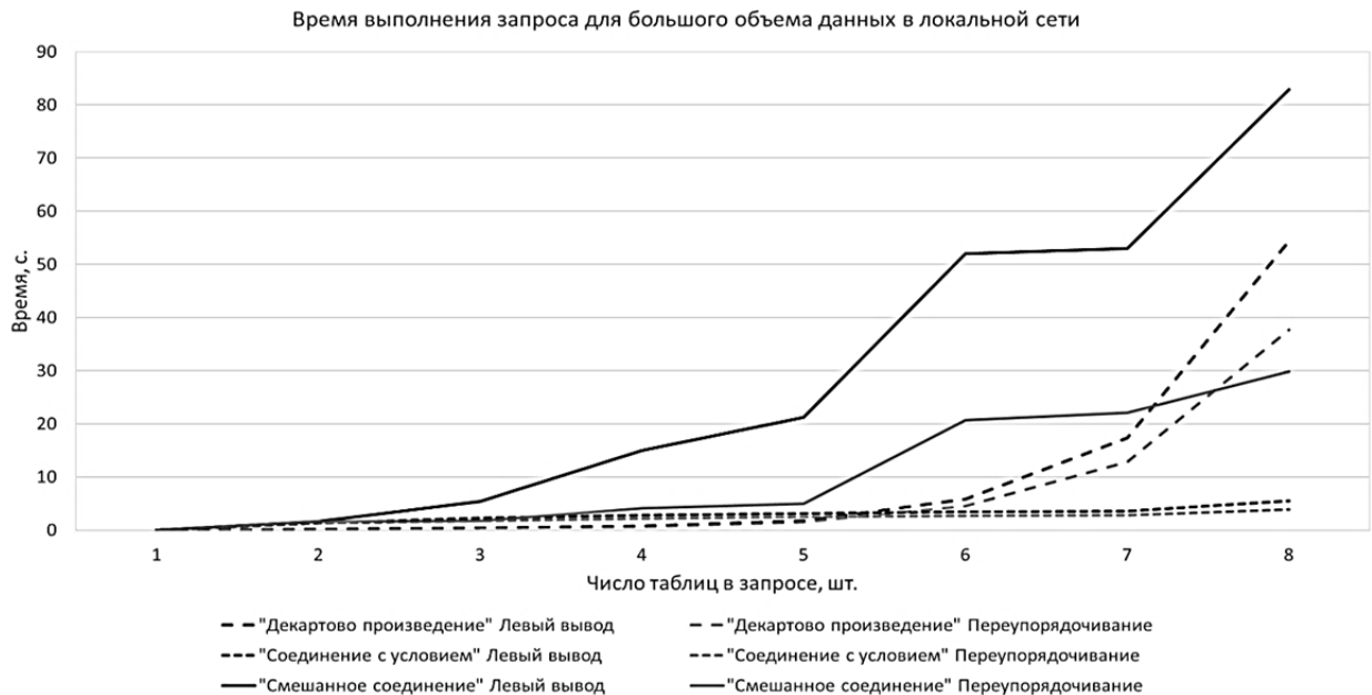
Рис. 6. Зависимость времени выполнения плана от числа таблиц в запросе для большого объема данных для запросов типа «декартово произведение», «соединение с условием» и «смешанное соединение» в локальной сети
