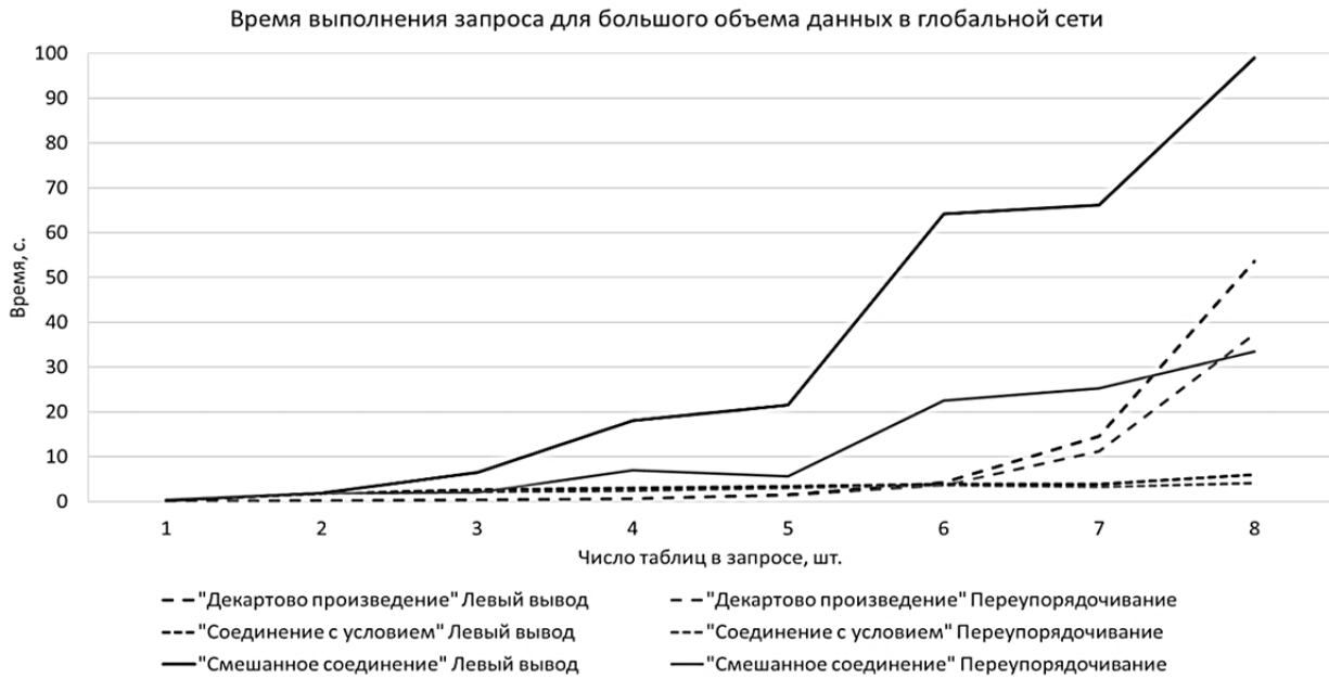
Рис. 8. Зависимость времени выполнения плана от числа таблиц в запросе для большого объема данных для запросов типа «декартово произведение», «соединение с условием» и «смешанное соединение» в глобальной сети
