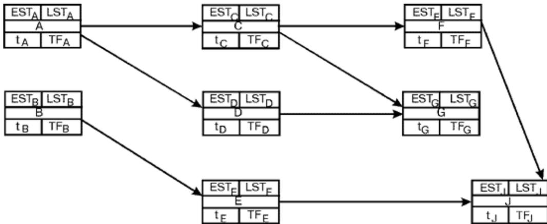
Рис. 2. Пример маркировки вершин сетевого графика модели типа AoN
