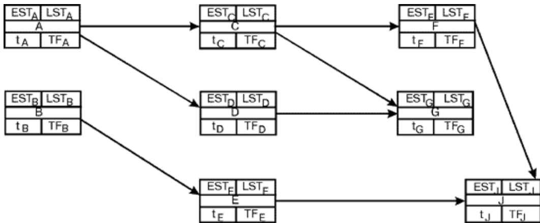
Рис. 2. Пример маркировки вершин сетевого графика модели типа AoN Fig. 2. Gantt schedule for the implementation of activities
