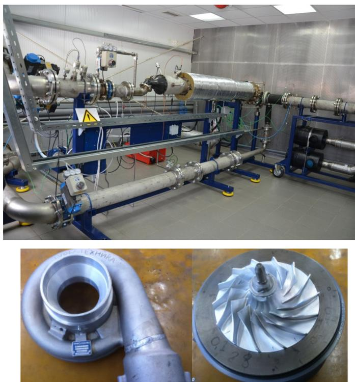
Рис. 5. Сверху – стенд испытаний турбокомпрессоров НПО «Турботехника».
