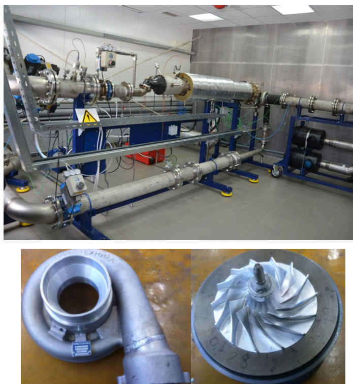
Рис. 5. Сверху – стенд испытаний турбокомпрессоров НПО «Турботехника». Снизу – внешний вид компрессора ТКР-175Э
