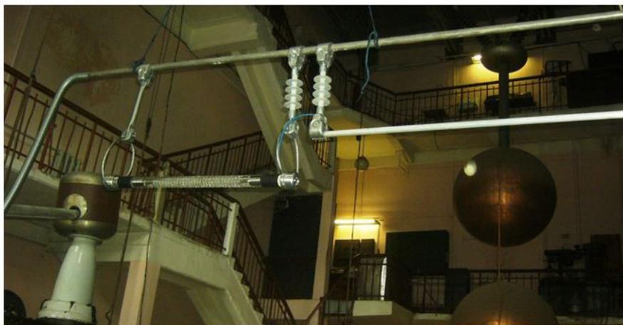
Рис. 7. АППС-С: лампа с арматурой на макете однофазной линии 190 кВ
