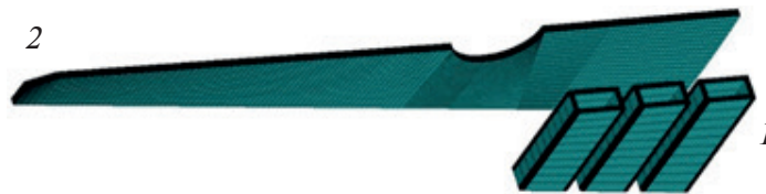
Рис. 2. Конечно-элементная 3D-система: 1 – индуктор, 2 – демпферная пружина
