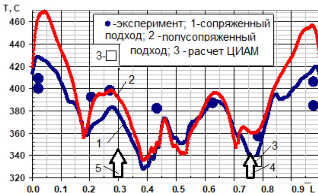
Рис. 6. Сравнение результатов расчета с опытными данными [11] (1,2 – сопряженный и полу-сопряженный подходы соответственно; 3 – метод Центрального института авиационного моторостроения (ЦИАМ) с применением граничного условия третьего рода
