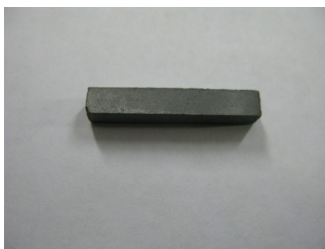
Рис. 1. Штабик из твердого сплава ВК8 в исходном состоянии Fig. 1. Stab made of VK8 hard alloy in its original state
