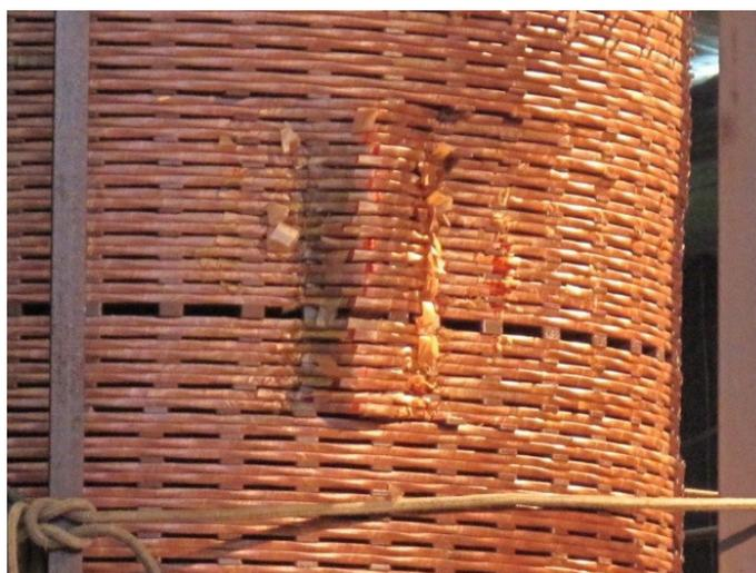
Рис. 7. Начало повреждения обмотки 500 кВ тр-ра 1Т 500 кВ, 1000 МВА Сургутской ГРЭС-2
