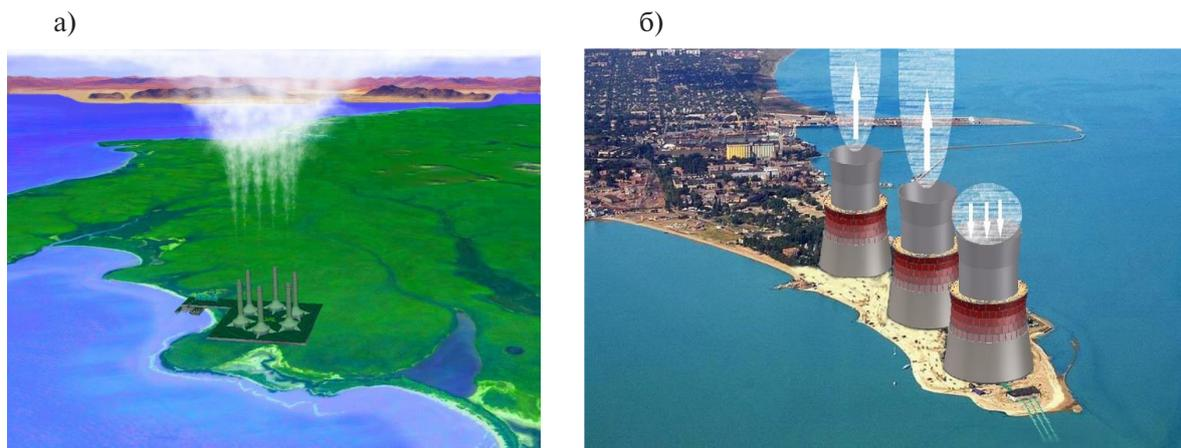
Рис. 5. Блоки аэротермического кулера с различным количеством инжекторов: а – с 6 (прибрежное материковое или островное базирование) и б – с 3 (прибрежно-полуостровное базирование)
