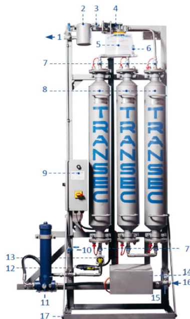
Рис. 7. Устройство технологии АСУ СИТО «TRANSEC» Fig. 7. Automatic online drying system «Transec»
