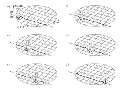
Динамика формы изгибных смещений w пластины радиусом R в моменты времени  $t = -3\Delta t$  (a),  $-2\Delta t$  (b),  $-\Delta t$  (c), 0 (d),  $\Delta t$  (e), T/2 (f), где  $\Delta t = T/(4\sqrt{3})$
