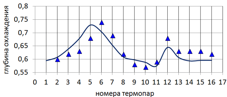
Рис. 2. Распределение глубины охлаждения вдоль профиля сопловой лопатки Fig. 2. Cooling depth distribution along the nozzle blade profile
