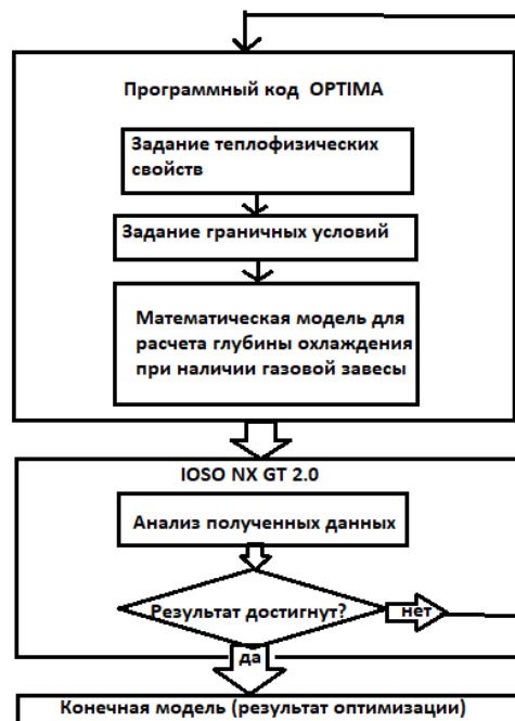
Рис. 4. Блок-схема единой информационной среды для расчета оптимальных параметров системы охлаждения сопловой лопатки
