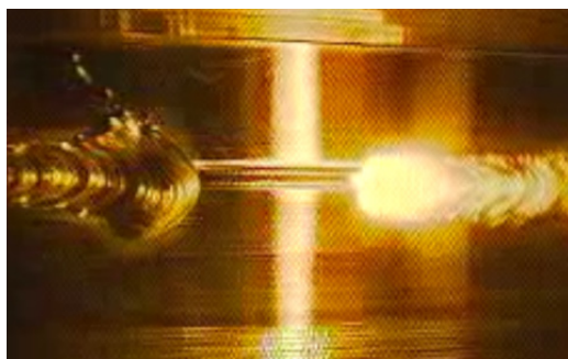
Рис. 11. Кадр перед замыканием кольцевого шва Fig. 11. Frame before closing the circumferential seam
