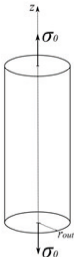
Рис. 1. Схема к постановке краевой задачи: цилиндрический образец радиусом r_{out} подвергается действию аксиальных растягивающих напряжений \sigma_0 и газового потока с боковой поверхности
