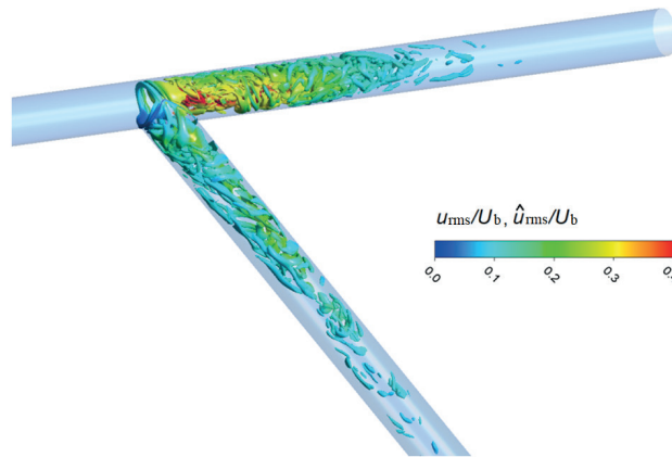
Рис. 6. Изоповерхность Q -критерия, окрашенная в соответствии со значениями среднеквадратичных пульсаций продольной скорости в двух ветвях канала
