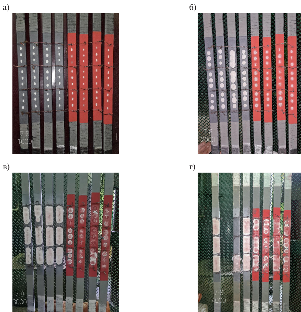
Рис. 7. Фотографии динамики изменения размера дефектов в полупроводящем покрытии конструкций макетов при длительных комплексных воздействиях: полупроводящая лента + полупроводящая эмаль (серый цвет покрытия-слева) и полупроводящая лента + полупроводящая эмаль + защитное диэлектрическое покрытие (красный цвет покрытия – справа): а) длительность 1000 ч; б) длительность 2000 ч; в) длительность 3000 ч; 4) длительность 4000 ч
