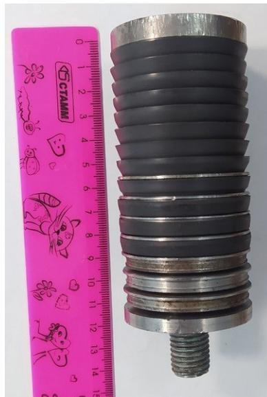
Рис. 4. Наборный манжетный поршень с 12-ю манжетными уплотнениями Fig. 4. Set cuff piston with 12 cuff seals
