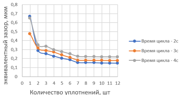
Рис. 6. Зависимость эквивалентного зазора от количества манжетных уплотнений
