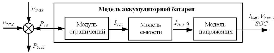
Рис. 3. Функциональная схема модели аккумуляторной батареи
