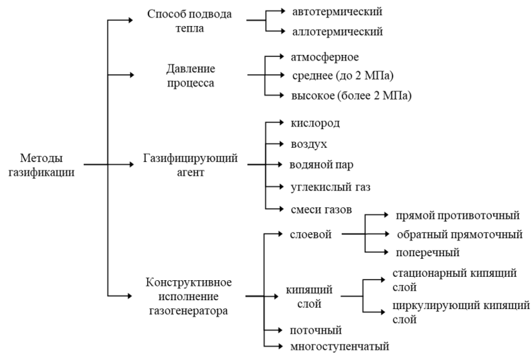
Рис. 1. Методы газификации ТКО и RDF-топлива Fig. 1. Gasification methods for MSW and RDF
