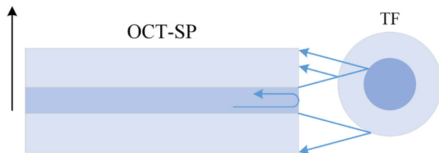
Рис. 3. Схематическое изображение взаимного расположения исследуемого волокна и ОКТ-зонда (в их поперечных сечениях):
