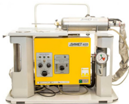
Рис. 2. Установка холодного газодинамического напыления с низким давлением «Димет-405»
