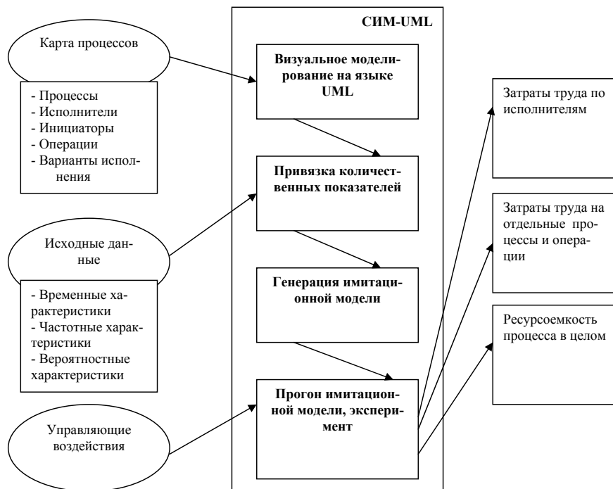
Рис. 1. Общая схема моделирования в системе СИМ-UML
