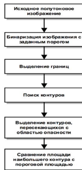
Рис. 2. Схема алгоритма обработки карты глубин
