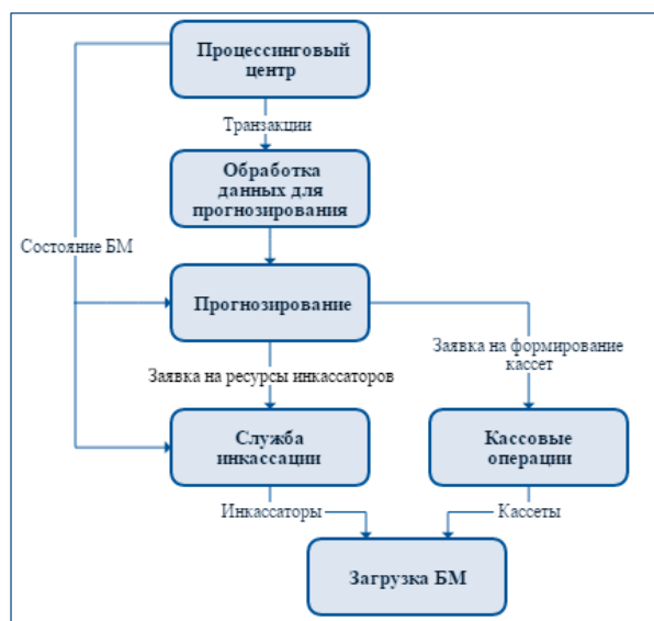
Рис. 1. Схема процесса инкассации банкомата [1]
