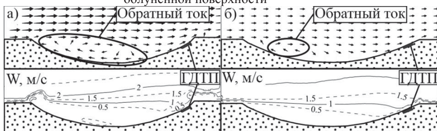
Рисунок 7. Скалярное и векторное поля скорости для лунки в ряду 2 (а) и в ряду 6 (б)
