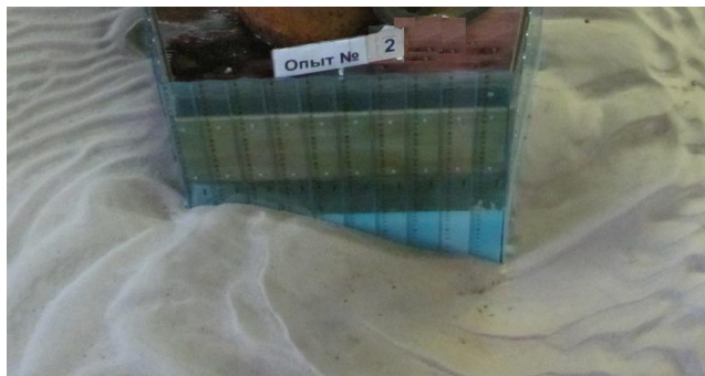
Рис. 2. Размыв у носовой части модели баржи после проведения опытов 1 (а) и 2 (б)
