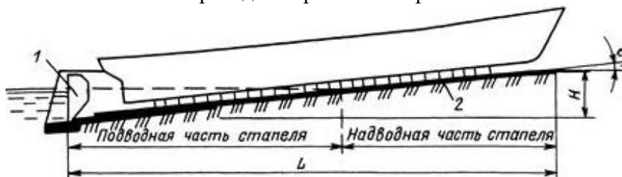
Рис. 3. Продольный наклонный стапель: 1 – батопорт; 2 – бетонная плита [7]
