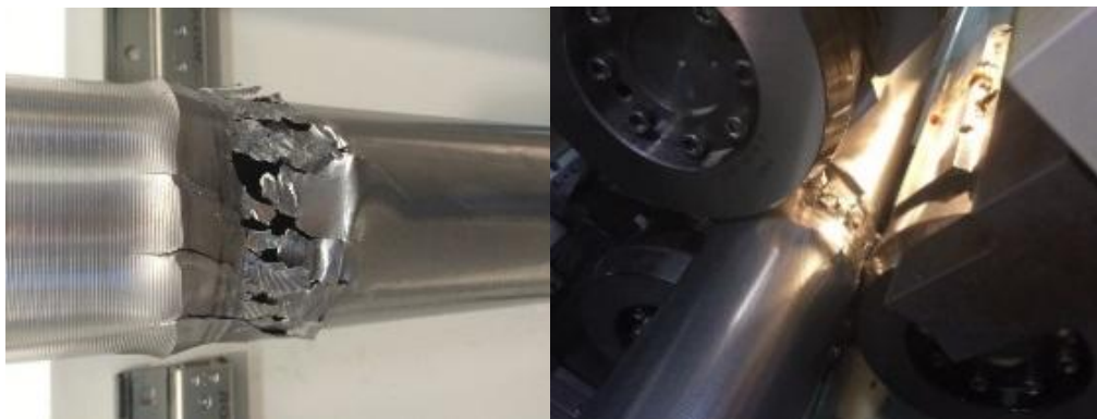
Рисунок 2. Разрыв трубы в процессе ротационной вытяжки
