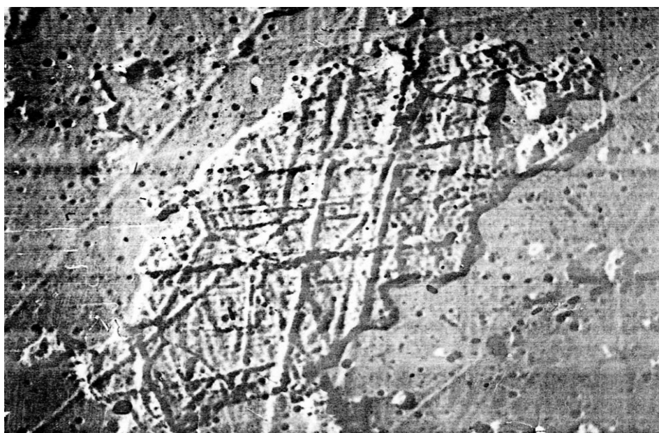
Рис. 3. Поры оксидно-карбидной керамики
