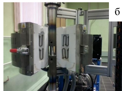
Рис. 3. Компьютеризированный стенд для испытаний на прочность:
