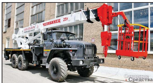
Рис.2. Автокран «Челябинец», оснащенный монтажной люлькой с высотой подъема людей до 35 м
