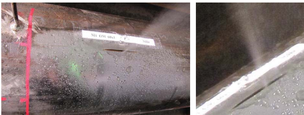
Рис.3. Разрушение (утечка среды) на модели Д15 при давлении ГИ P=90 кг/см 2
