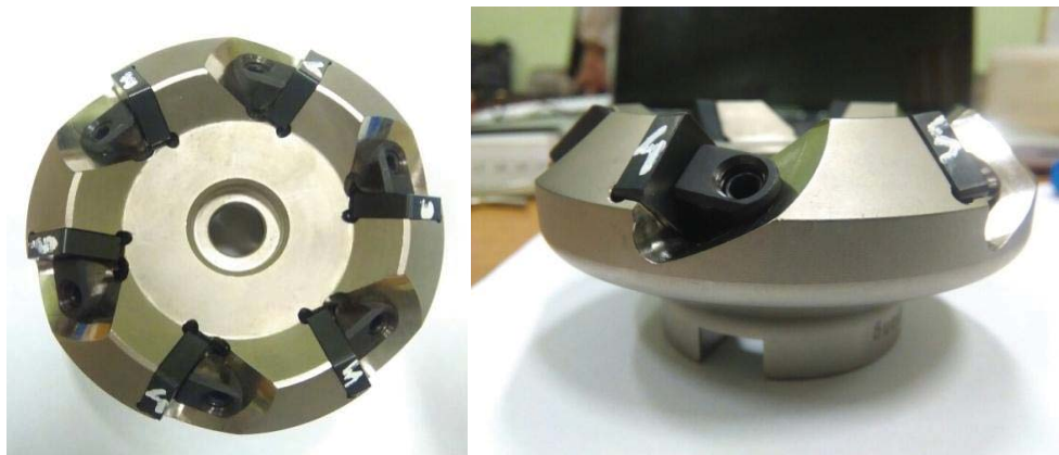
Рис. 4. Торцевая фреза, оснащенная сменными керамическими пластинами с учетом их микроструктурных параметров
