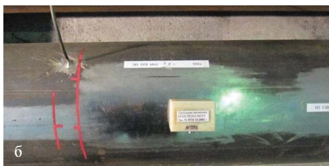
Рис. 2. Концентратор напряжений в виде полуэллиптической трещины длиной 60 мм и глубиной 4,8 мм на поверхности трубы 219х6 мм (а) и варианты установки ПАЭ и их расположение относительно искусственных дефектов (б): через волновод (слева на фото) и с помощью магнитного держателя (в центре фото) на модели Д15
