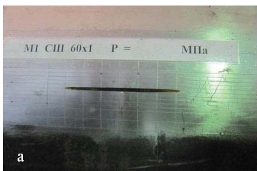
Рис. 2. Концентратор напряжений в виде полуэллиптической трещины длиной 60 мм и глубиной 4,8 мм на поверхности трубы 219х6 мм (а) и варианты установки ПАЭ и их расположение относительно искусственных дефектов (б): через волновод (слева на фото) и с помощью магнитного держателя (в центре фото) на модели Д15
