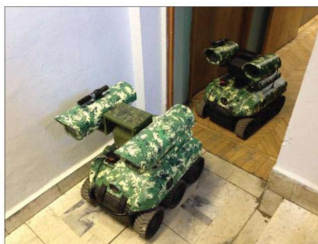
Рис. 4. Испытания комбинированного метода управления движением строя роботов: а) моделирование движения строя в симуляторе Stage; б) движение строя роботов «Пластун»
