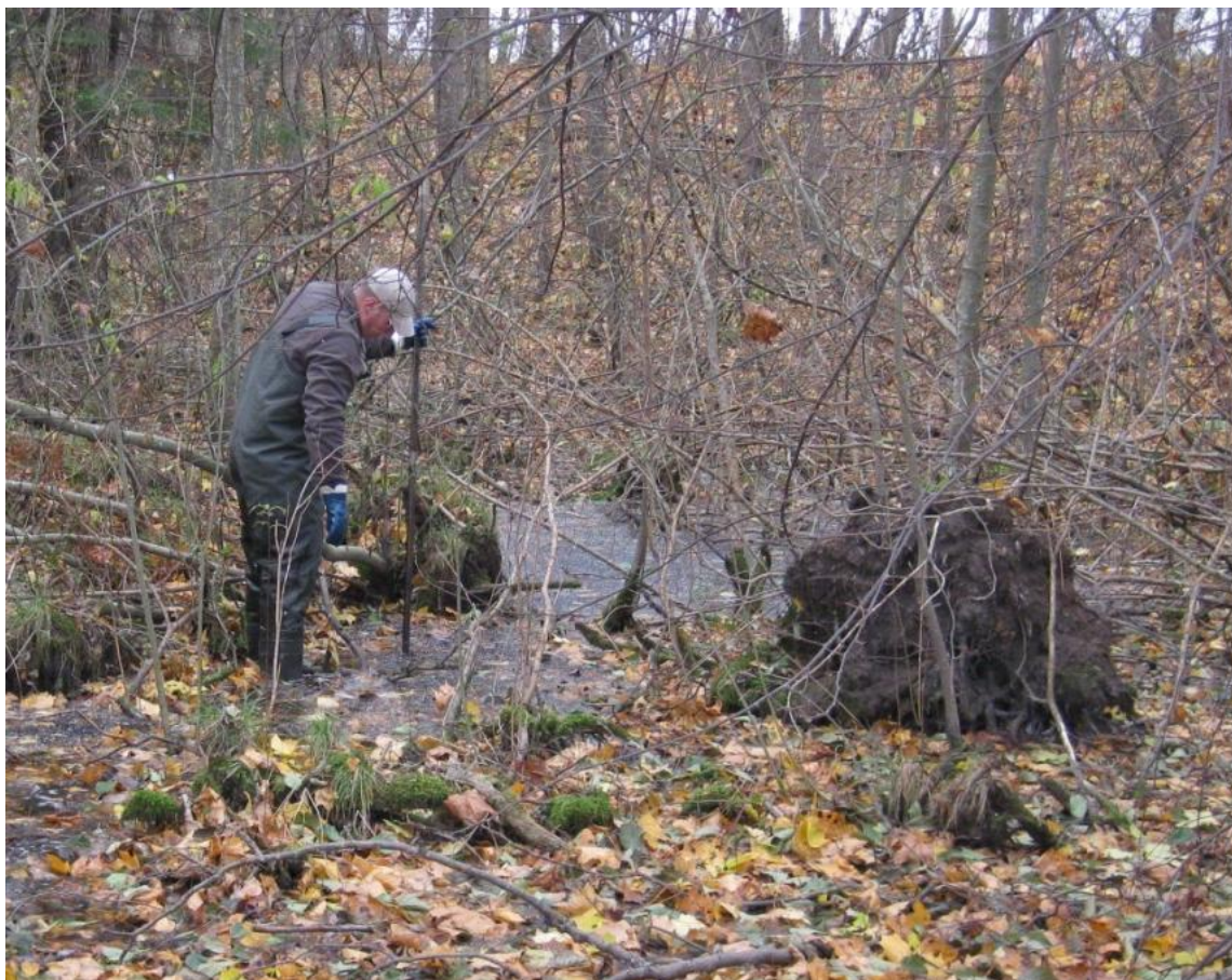
Рис. 1. Определение мощности иловых отложений Сухого пруда
