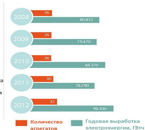
Рис. 2. Ввод гидроагрегатов и выработка электроэнергии ГЭС Три ущелья
