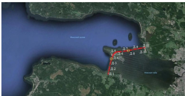
Рис. 4. Схема Комплекса защитных сооружений г. Санкт-Петербурга от наводнений
