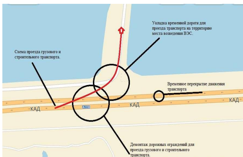
Рис. 1. Схема необходимых работ для доставки основных компонентов ВЭУ
