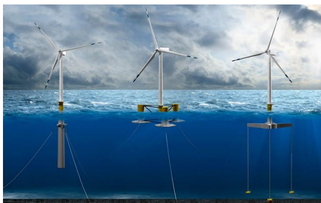
Рис. 1. Типы плавучих оснований. Слева направо: SPAR, полупогружное, TLP
