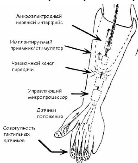
рис.5. Структура протеза с естественной чувствительностью
