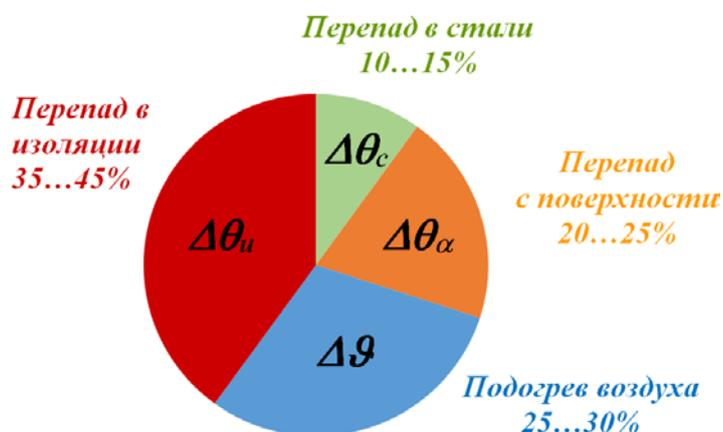
Рис. 2.2. Компоненты превышения температуры обмотки статора турбогенератора серии ТЗФ
