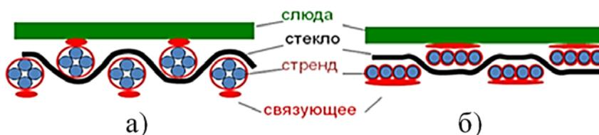
Рис.2.4. Структура изоляционных лент: а – лента стандартной структуры; б – лента с оптимизированной структурой.
