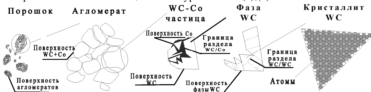
Рис. 3. Структурные элементы строения WC-Co порошкового материала.
