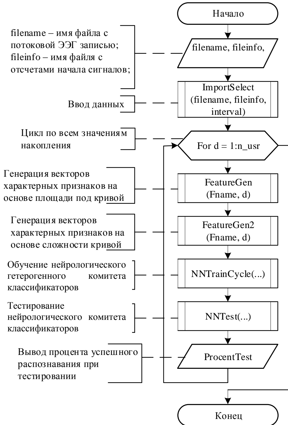
Рис. 2. Структура модулей системы анализа и классификации ЭЭГ паттернов моторных команд.
