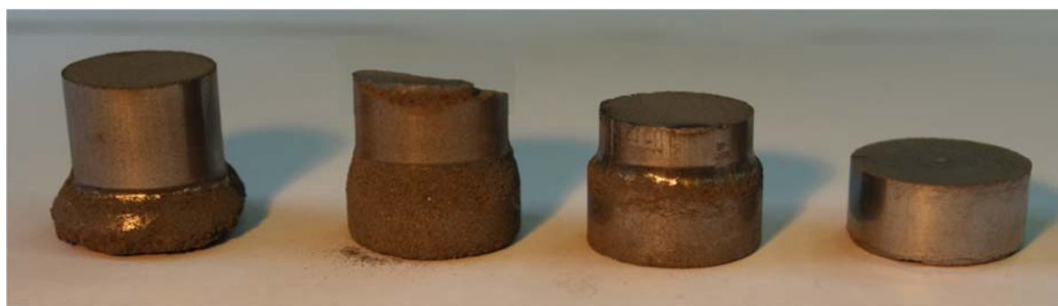
Рисунок 20 – Характерные этапы постадийного формообразования
