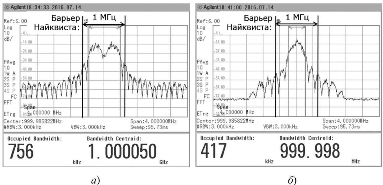
Рис. 3.13. Примеры энергетических спектров многокомпонентных сигналов со случайными последовательностями символов и с оптимальными импульсами, полученными с единственным ограничением свободного евклидова расстояния d_{\text{св}}^2 = 2,0 (а) и с единственным ограничением пик-фактора сигнала \text{PAPR} = 4,5 (б)
