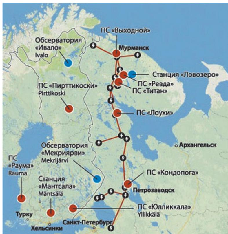
Рисунок 1.3. Схема расположения точек измерения в ЭЭС Кольского полуострова [21]
