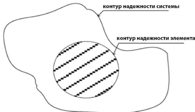
Рисунок 4.15. Графическое представление метода критической компоненты
