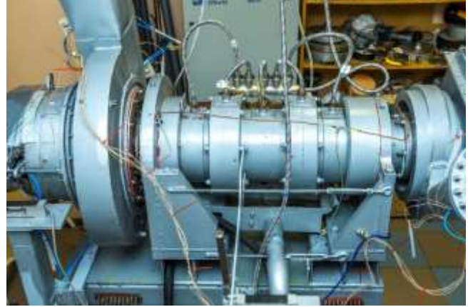
Рисунок 19 Фотография экспериментальной установки для исследования проточных частей МРТ и МЦК (вид слева)
