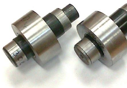
Рис. 9 Втулки с запрессованными валами с полиамидным покрытием.
