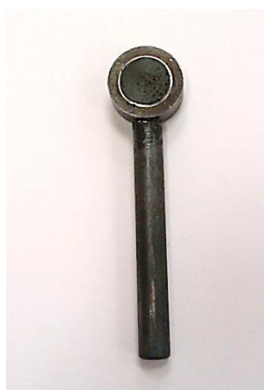
Рис. 4 Образцы для испытаний. 1 - полиамидное покрытие.
