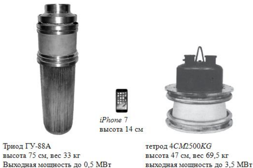
Рисунок 1.1.5. Генераторные лампы
