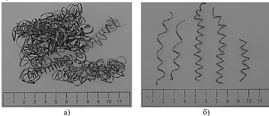
Рисунок 11 – Фотография стружки: а – сливная стружка при обычной механической обработке стали 40X с режимами V = 90 м/мин, S = 0.2 мм/об, t = 0.3 мм; б - сегментированная стружка после точения стали 40X с метастабильной структурой
