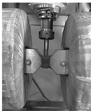
Рисунок 2 – Процесс магнитно-абразивного полирования на станке с ЧПУ
