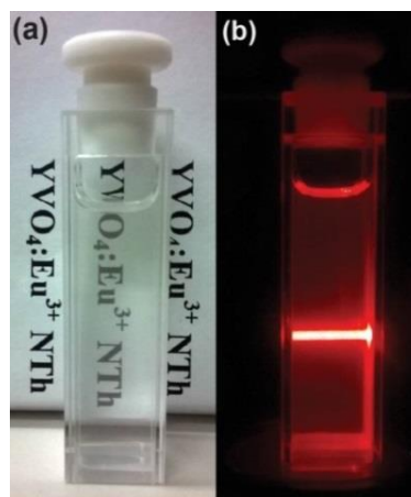
Рис. 3. Фотографии коллоидного раствора наночастиц \text{YVO}_4:\text{Eu}^{3+} (5 мол.%) при дневном свете (а) и подсветке УФ излучением (б)
