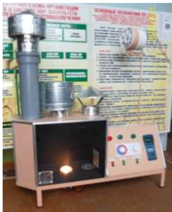
Рисунок 6 – Исследовательский стенд для испытания аэродинамических характеристик дефлекторов:
