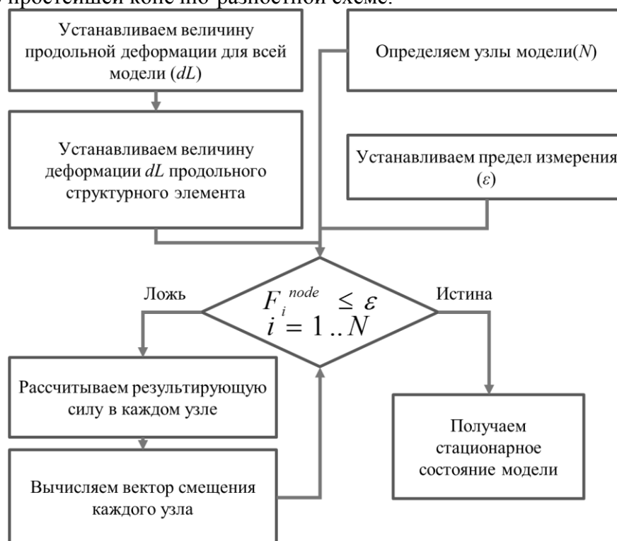
Рис. 2. Блок-схема алгоритма расчета состояния модели при заданных геометрических параметрах.
