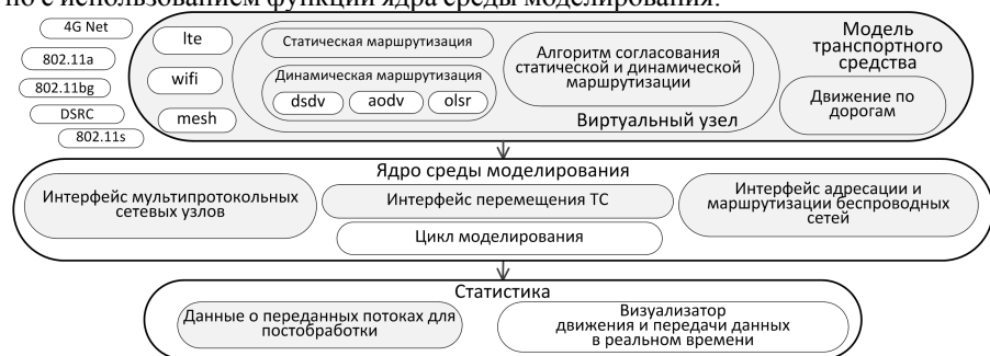
Рис. 3 — Компоненты имитационной модели функционирования телематической компоненты ИТС
